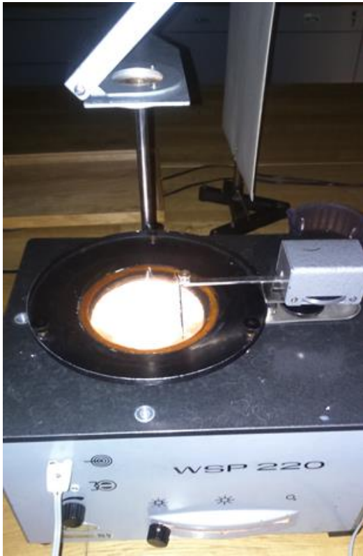
Hullámkád egyeneshullámok létrehozása közben, a kivetített stroboszkópos képpel. A hullámkád gyakorlatilag nem más, mint egy rezgő hullámkeltővel és kis káddal felszerelt írásvetítő.
