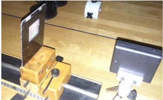
Drótszál megvilágítása lézerrel
