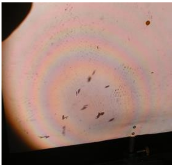
Átmenő fényben kirajzolódó színes Newton-gyűrűk
