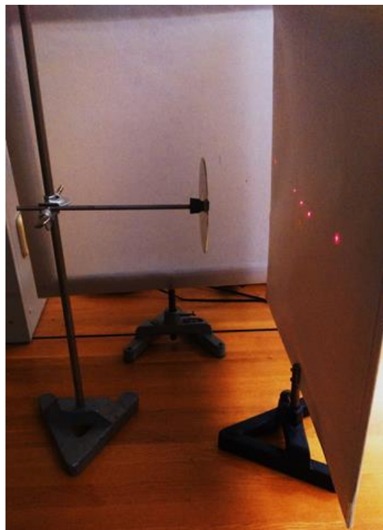
Bal fent: megvilágított lyukas ernyő; bal lent: összeállítás elvi vázlata; jobb: CD elhelyezése a lyukas ernyő mögött, a kialakuló mintázattal
