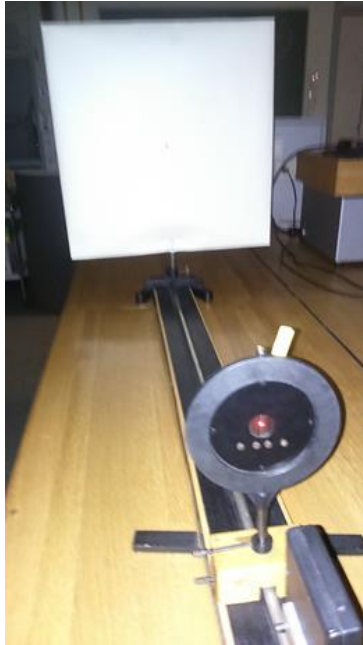
Optikai sínen lézerrel megvilágított változtatható szélességű rés és a kialakuló mintázat
