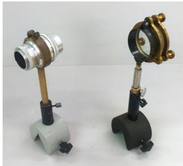
Fényképezőgép objektív (menetes fele az ernyő felé álljon), és a Newton-készülék
